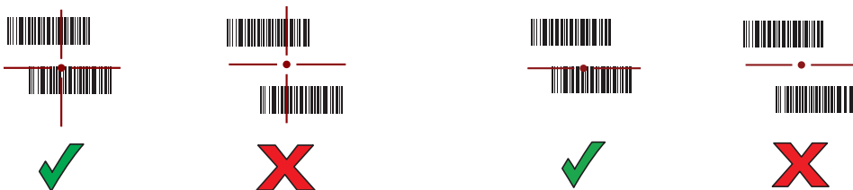
Рис. 39 Режим списка выбора в случае наличия нескольких штрихкодов в прицельной рамке: стандартный и расширенный диапазон
