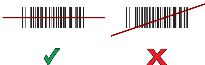
Рис. 40 Пример наведения лазерного сканера на штрихкод
